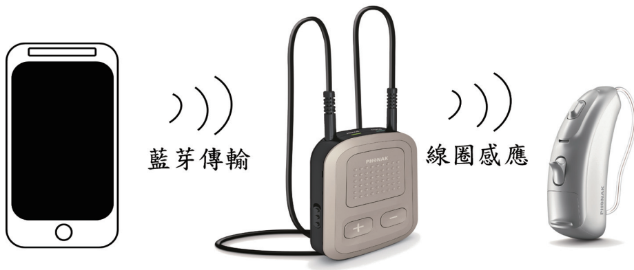
圖 5-15 手機透過藍牙配件傳送訊號至助聽器
