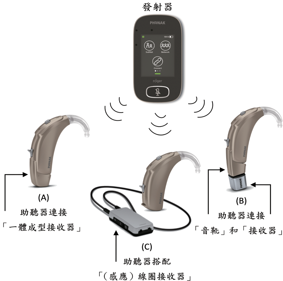
圖 5-13 助聽器與遠端麥克風系統搭配示意圖
