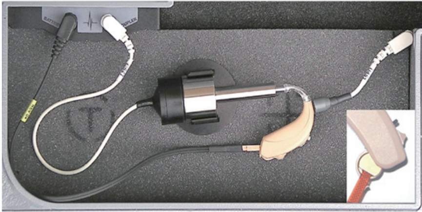
圖 5-11 助聽器耗電量測試之連接與擺放(以耳掛型助聽器為例)
