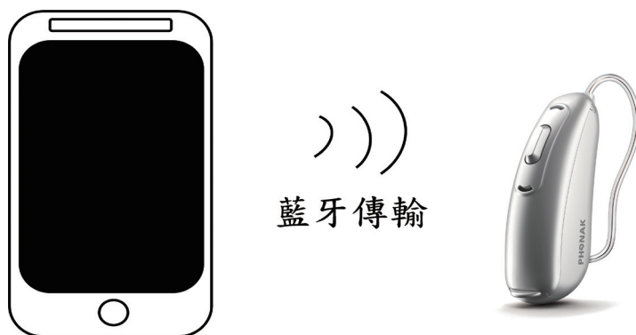
圖 5-16 手機透過藍牙方式與助聽器直接溝通
