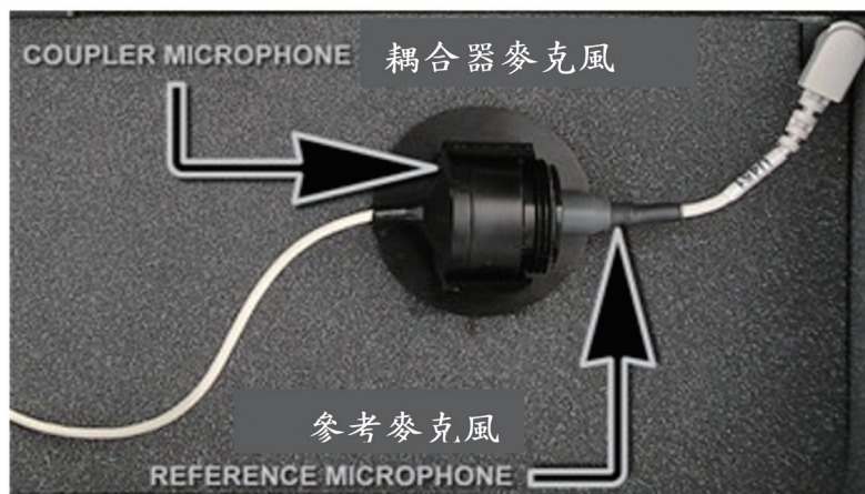
圖 5-7 參考麥克風與耦合器麥克風於音箱校正之擺放
